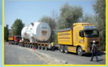
300 ton Siemens Gaz Türbini Nakliyesi
