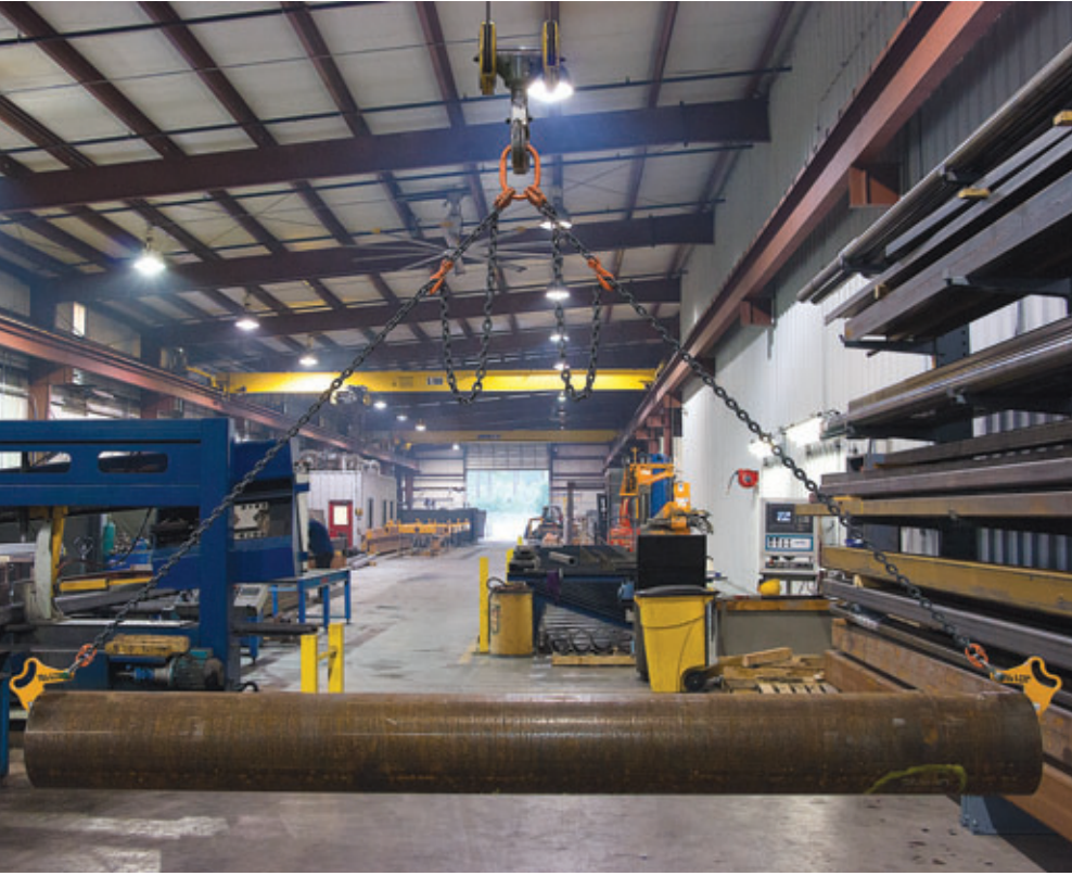
Tandemloc boru kancaları, farklı boru uzunlukları için kullanılabilir şekilde, uzunluğu ayarlanabilen zincirlerle birlikte teslim ediliyor
