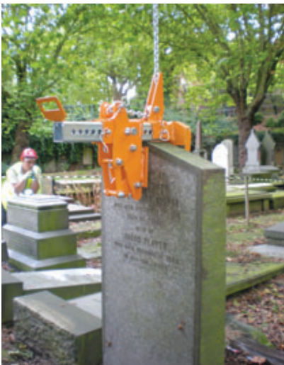
GGR Grubu'nun ürettiği kanca altı donanımları arasında, taş blok tutucular da var
