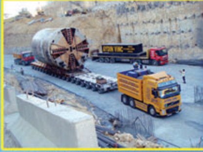
İstanbul'da 450 ton TBM nakliyesi
