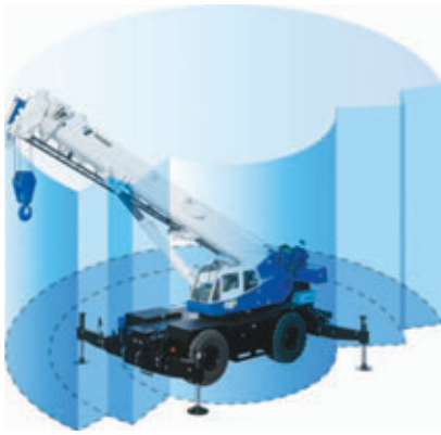
Tadano arazi vinçlerinde kullanılan LMI teknolojisi, destek ayaklarının açılma mesafesini otomatik olarak algılıyor
