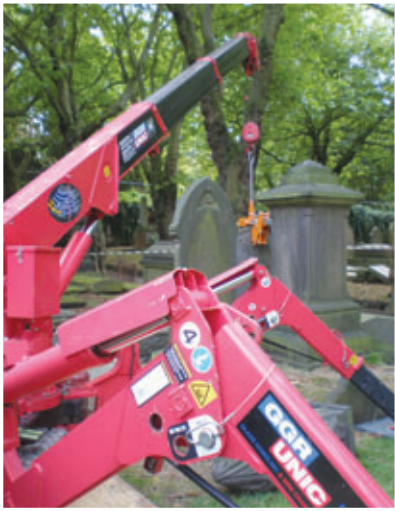
Bir taş blok tutucu, GGR Grubu tarafından imal edilmiş Unic URW-095 ayaklı vinçle birlikte kullanılıyor
